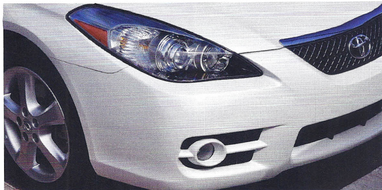
Das Xirallic-Pigment Crystal Silver lässt ein Weiß weißer erscheinen als das leicht gelbliche Iridin-Weiß. Wer als Lackierer diese Mischlacke aufspritzen will, sollte an den weißen Untergrund denken. Beim Iridin Silberweiß reichen einige Tropfen Schwarz, um den gelblichen Charakter zu plätten
