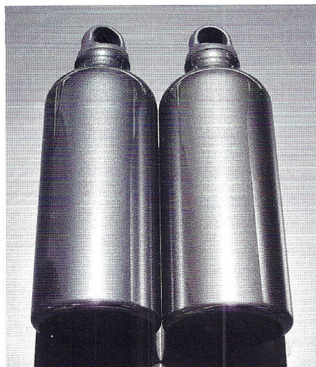
Im Vergleich sieht man deutlich den Glanzunterschied zwischen einem weißen Xirallic- und einem weißen Iriodin-Pigment (rechts). Der Glanz beim Xirallic-Pigment ist intensiver und enger
