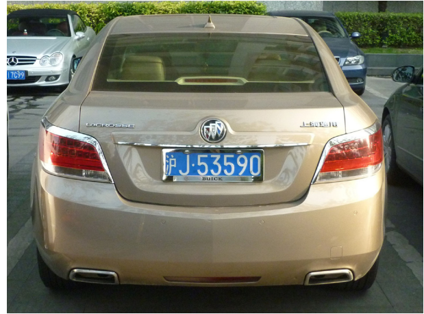
Abb. 2 // Metallicfarben zeigen einen starken Helligkeitswechsel in Abhängigkeit vom Betrachtungswinkel.
