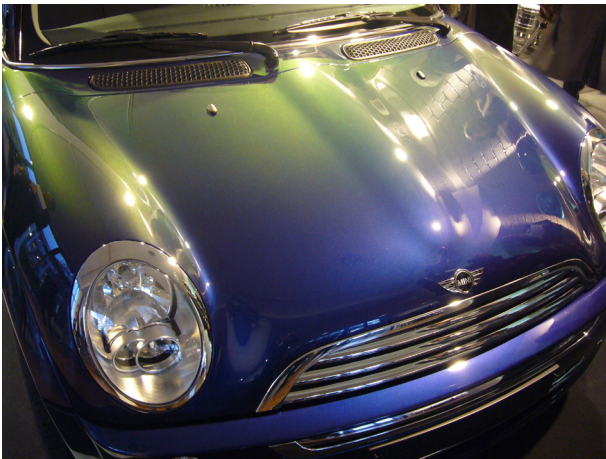
Abb. 1 // Bunte Interferenzpigmente sorgen für fließende Übergänge zwischen den Farben. Sie werden in vielen Lackrezepturen eingesetzt, so wie auch in der Autolackierung.
