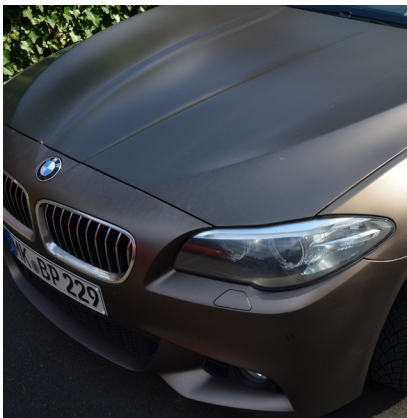
Abb. 8 // Matte Lackierungen liegen im Trend, spielen aber trotzdem nur eine geringe Rolle. Sowohl in der Serien- als auch bei der Reparaturlackierung sind sie nicht unproblematisch.
